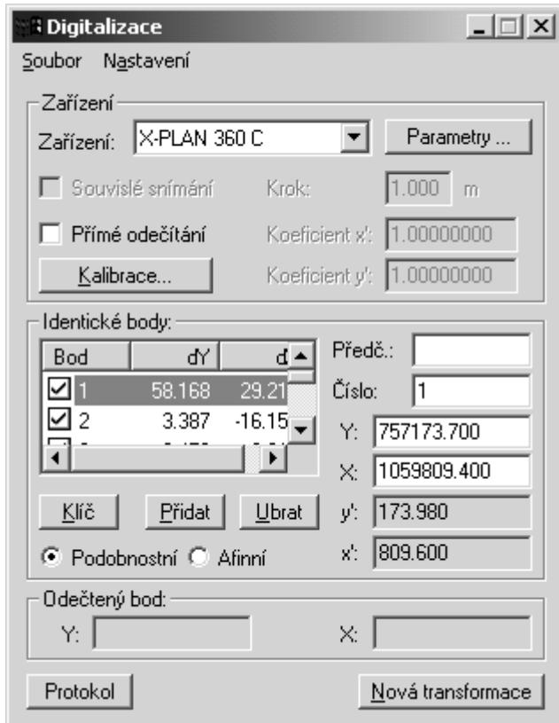
Modul služi za priključenje opreme za digitalizaciju. On vam omogućava priključenje digitalnog planimetra (tip XPlan ili Tamaya), ili proizvoljnog digitajzera.
