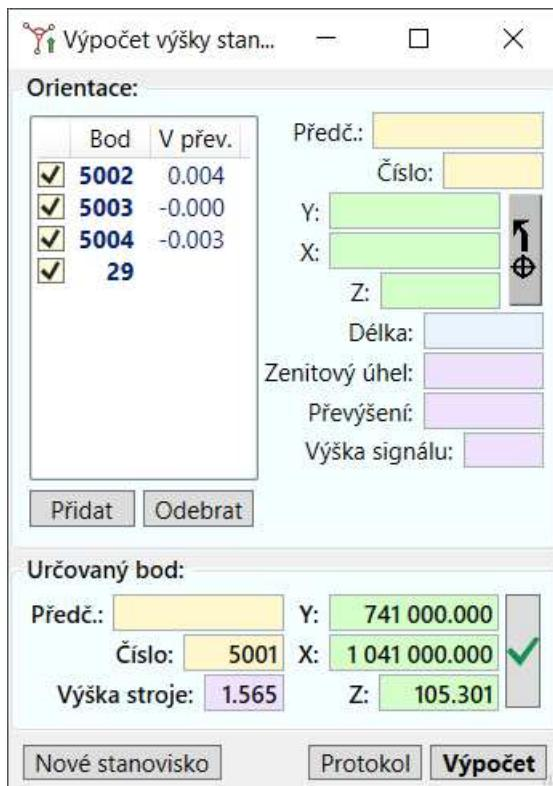
Výpočetní okno se ovládá stejně, jako okno pro výpočet volného stanoviska, zadávají se však do něj pouze údaje pro výškový výpočet (souřadnice stanoviska, výška stroje souřadnice a výšky orientací, výšky cíle na orientacích a převýšení nebo zenitové úhly).
