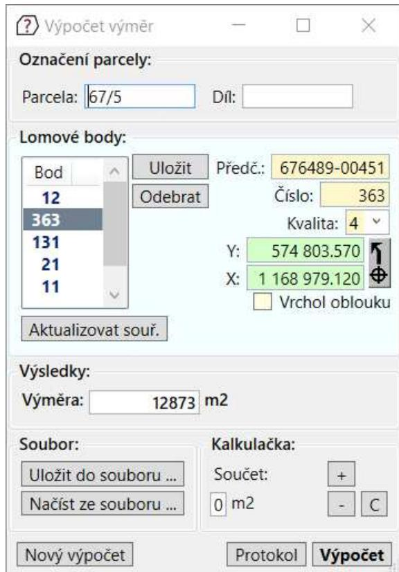
Body se do seznamu přidávají způsobem obvyklým u ostatních úloh. Jsou-li souřadnice bodu přetaženy myší, program je do seznamu přidá automaticky, bez stisknutí tlačítka (**Přidat**). Máte-li lomové body označeny v seznamu souřadnic (a jsou-li ve správném pořadí), můžete je přetáhnout všechny najednou jako blok (prostředním tlačítkem myši).
